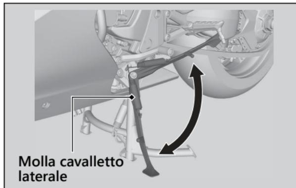
1. Controllare che il cavalletto laterale funzioni regolarmente. Se il cavalletto laterale è duro o cigola, pulire la zona intorno al perno e lubrificare il bullone del perno con del grasso pulito.
